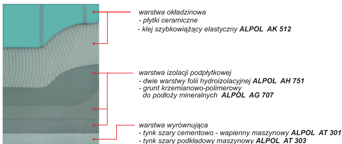
Schemat systemu dla hydroizolacji pionowej
