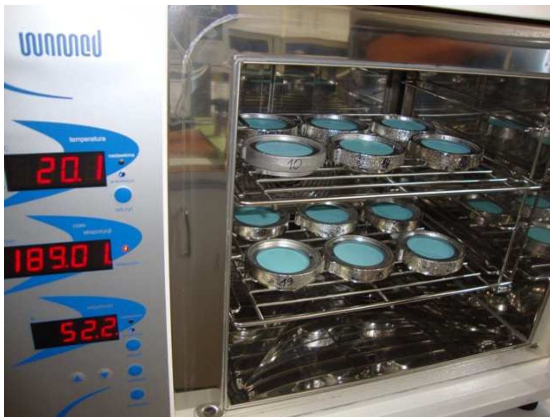
Próbki farb w komorze klimatycznej podczas badania
