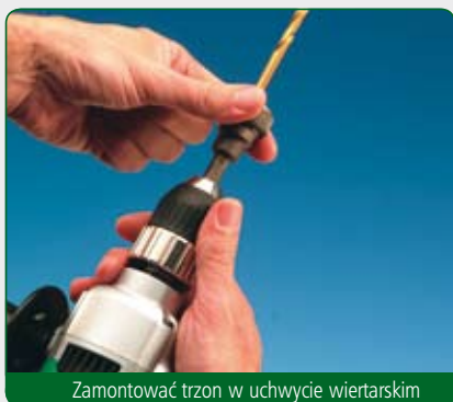
Zamontować trzon w uchwycie wiertarskim
