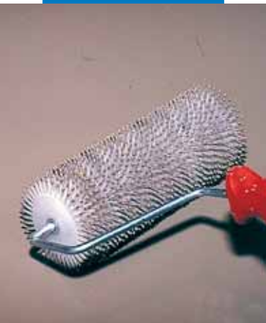
Rozprowadzanie masy Novoplan 21 na świeżo przy pomocy wałka
