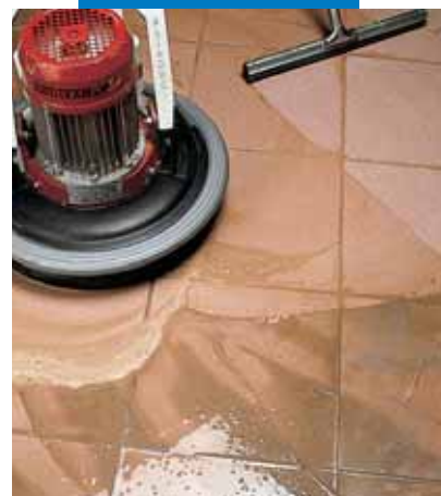
Czyszczenie podłogi z gresu porcelanowego przy użyciu maszyny czyszczącej i rakli
