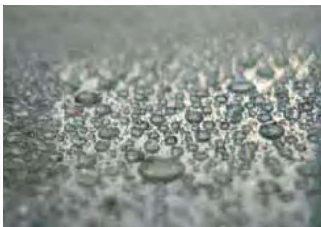
Powierzchnia zabezpieczona impregnatem.
