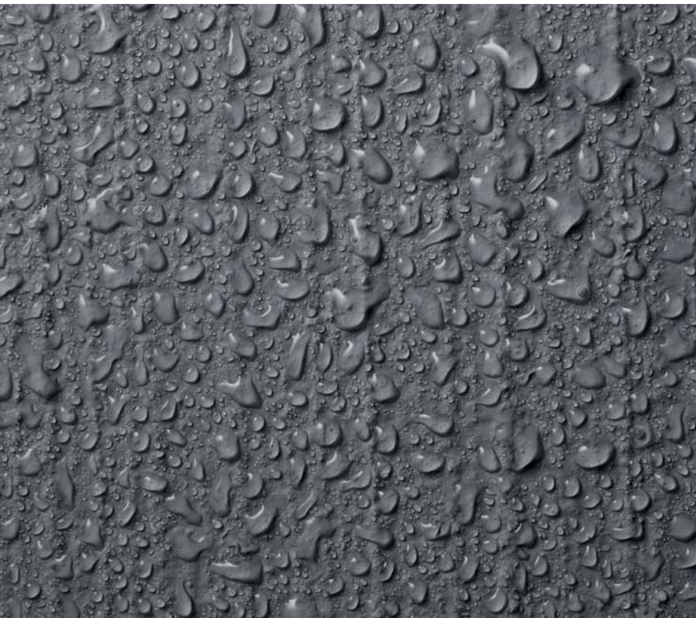
EFEKT HYDROFOBOWY NA POWIERZCHNI POMALOWANEJ FARBĄ SILIKONOWĄ ATLAS SALTA N PLUS
