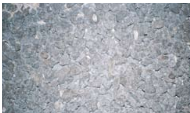
Porowaty jastrych cementowy z otwartymi porami.
