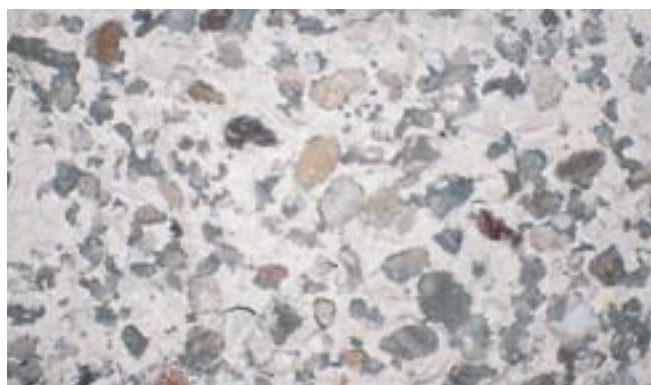
Spójna struktura po zastosowaniu zaprawy iniekcyjnej do usuwania pustek pod płytkami Sopro Soprodur®.
