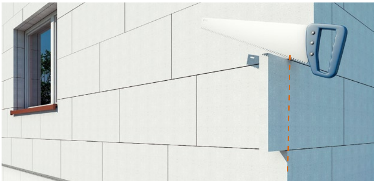
Rys. 13. Docinanie płyt na narożnikach budynków
