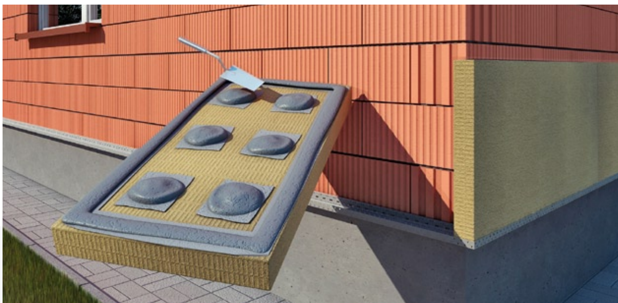
Rys. 7b. Nakładanie zaprawy klejącej na powierzchnię płyty z wełny mineralnej
