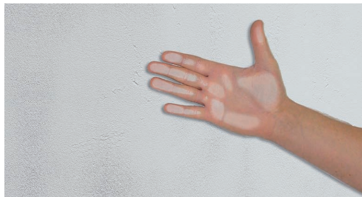
4. Podłoże skredowane, wymagające wzmocnienia
