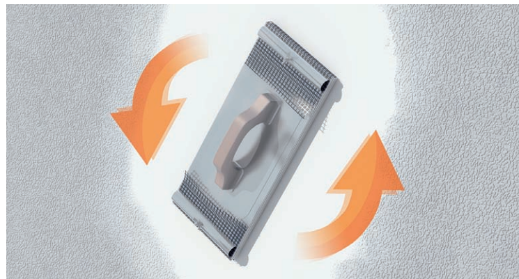
33. Szlifowanie szpachlowanej elewacji
