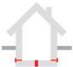
Uszczelnienia przerw roboczych
